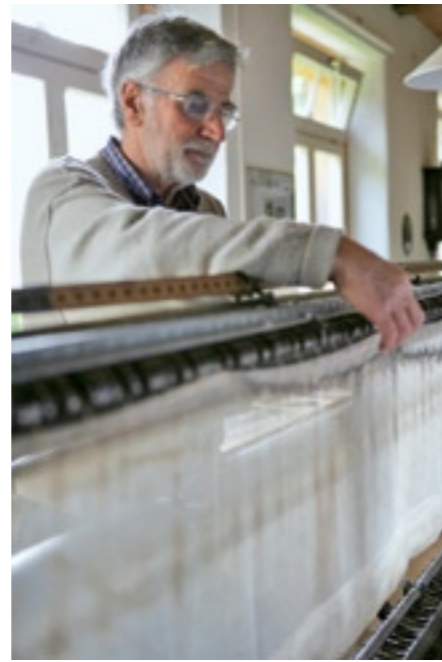
Sorgfältig werden die 312 Nadeln auf die Maschine gesteckt.
